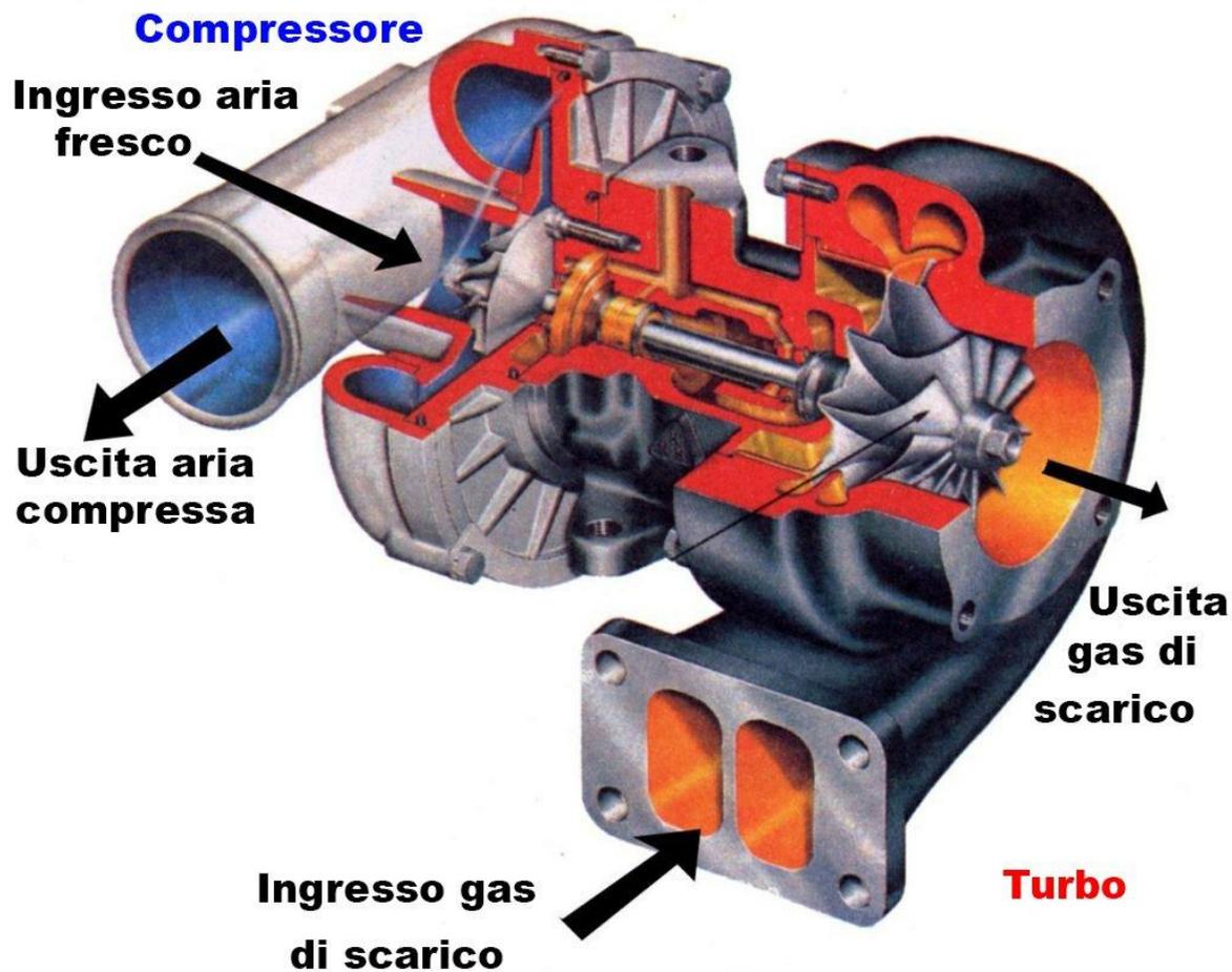
Inventato nel 1905 da Alfred Büchi (ingegnere svizzero), il **turbocompressore**, più comunemente noto come **turbo**, aumenta le prestazioni del motore comprimendo una maggiore quantità d'aria in entrata motore.
